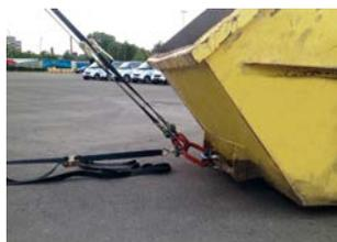
Les lests et réservoirs de ballast servent à fixer les écrans sur surfaces goudronnées.
