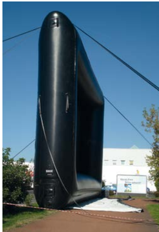
Aufstellen einer Leinwand 16 m x 8 m innerhalb weniger Minuten durch die Kraft eines leistungsstarken Gebläses
