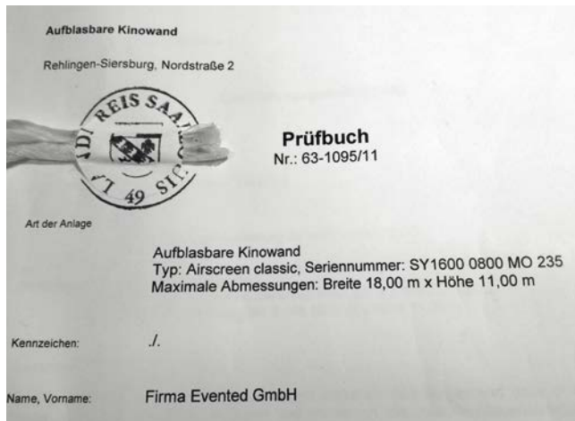
Auszug aus dem Prüfbuch einer Leinwand 16 m x 8 m gemäß der Fliegende Bauten Richtlinie
