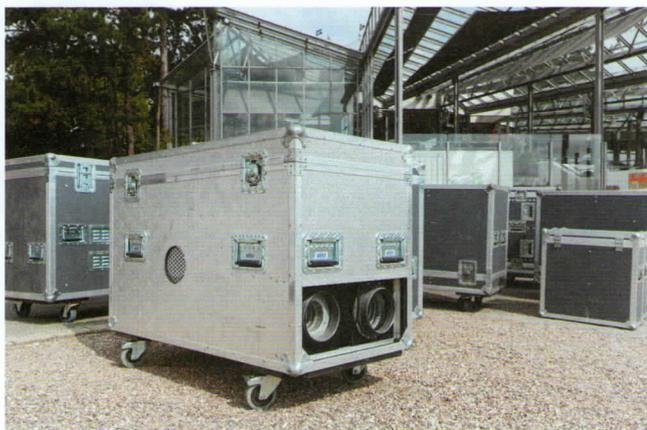
**Das Gebläse** stammt vom britischen Hersteller Gibbons und ist in einem schallgedämpften, mit Rollen versehenen Case untergebracht
